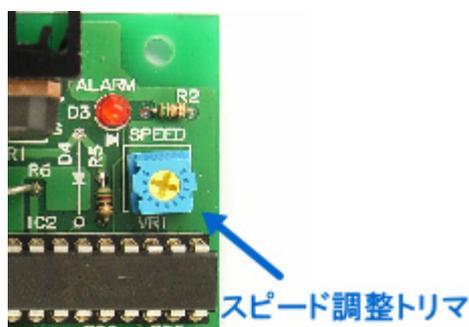
スピード調整トリマでフェード・イン / フェード・アウト動作のスピード調整を行ってください。
