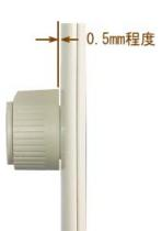
ツマミはプレート面と接触しない ように 0.5mm 程度の隙間をあけて 取り付けてください。
