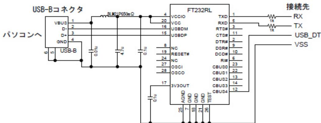
参考商品 USB シリアル変換モジュール (秋月電子通商製)
